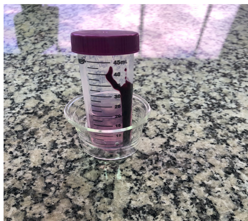
Figura 2 - Extrato obtido das cascas de uva junto com etanol 80% em tubo de Falcon.
