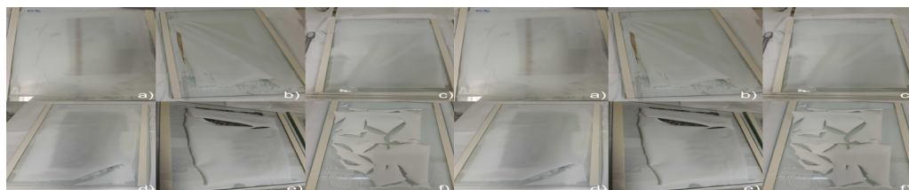
Figura 1: Filmes de PBAT/HAp: a) 1%; b) 3%; c) 5%; d) 10%; e) 15% e f) 20%.
