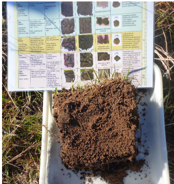
Figura 3. Bloco de solo extraído da camada de 0,00-0,20 m sobre uma bandeja plástica e tabela de classificação (BALL et al., 2007; GUIMARÃES et al., 2011) para posterior avaliação visual da estrutura do solo (VESS).
