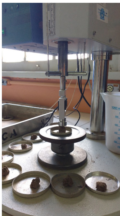
Figura 2. Atuador eletrônico linear e amostras sendo avaliadas a resistência tênsil dos agregados solo. Fonte: autora.
