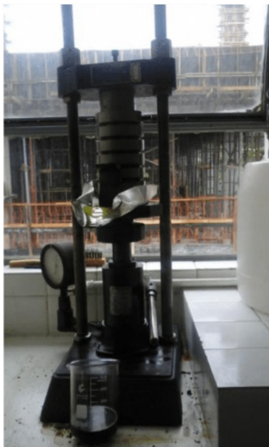
Figura 2: Imagem ilustrativa de uma Prensa hidráulica para extração de óleo e do Processo de prensagem da polpa de abacate liofilizada.
