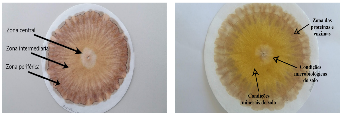
Figura 3 - Representação cromatograma, em A: zonas central, intermediária e periférica e em B: condições do solo conforme cada zona. (Fonte: Os autores, 2018).
