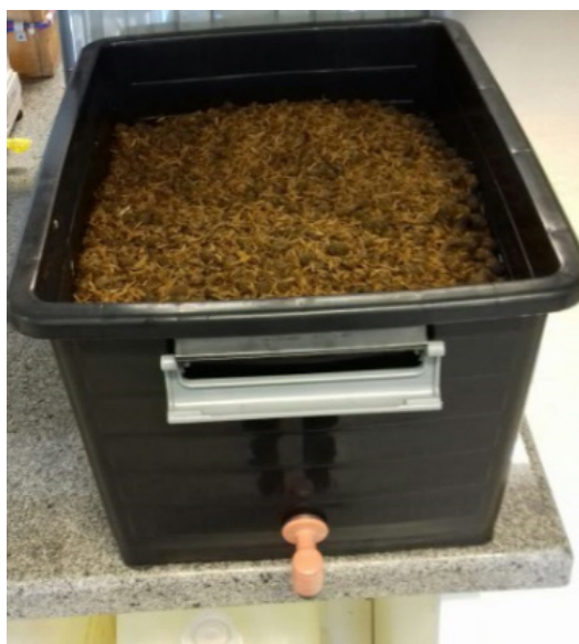
Figura 7 – Modelo de caixa utilizada para a experimentação com 20 litros da mistura (75% esterco de coelho e 25% casca de arroz)
