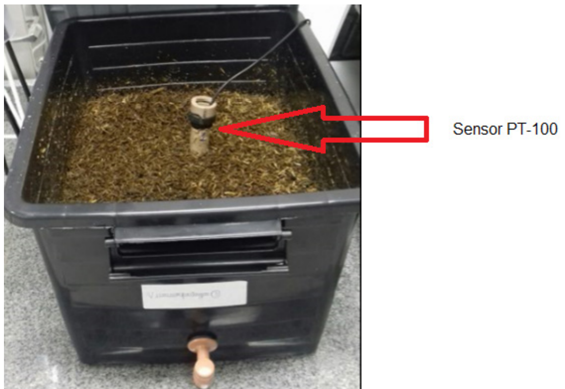
Figura 11 – Instalação do sensor PT-100 no centro do vermirreator
