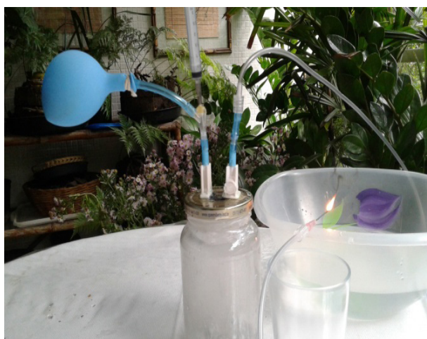
Figura 3: Gerador de gás desenvolvido para produzir acetileno.
