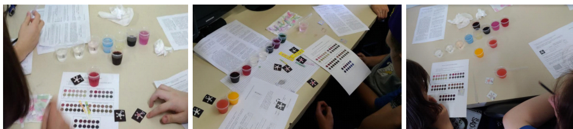
Figura 11. Estudantes executando a terceira atividade experimental, utilizando o dispositivo em formato de flor para análise de pH dos sucos industrializados sabor uva, laranja e morango.
