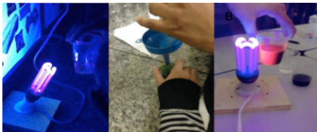
Figura 3: Água com gás frente a luz UV (esq.). Extrato do espinafre frente a luz ambiente (centro). Extrato do espinafre frente a luz UV (dir.)
