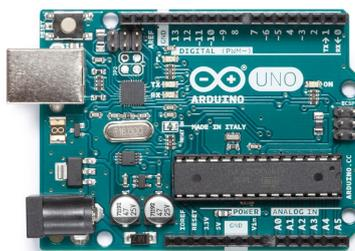
Figura 1 - Placa Arduino UNO
