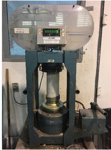
Figura 6 – Ensaio de compressão simples
