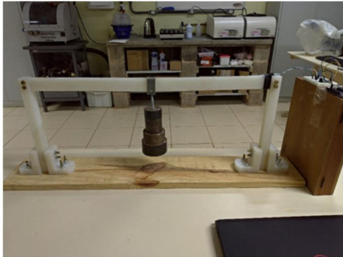
Figura 5 - Carregamentos a 300 mm do extensômetro
