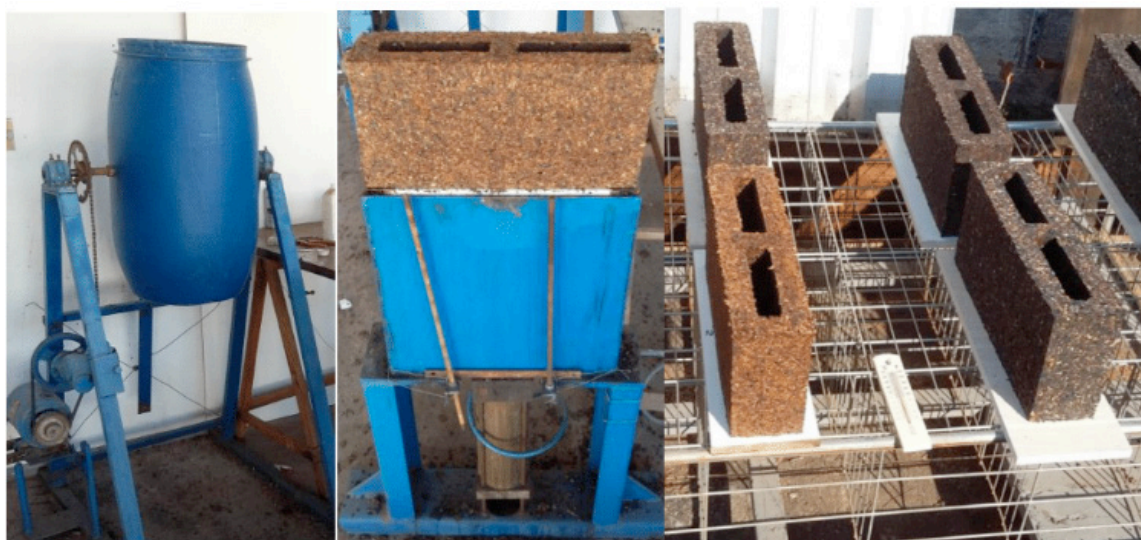
Figura 5 – Misturador / Desforma na prensa pneumática / Cura dos blocos
