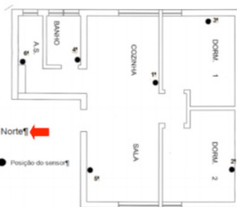
Figura 4 – Instalação dos sensores no apartamento do estudo de caso 2.
