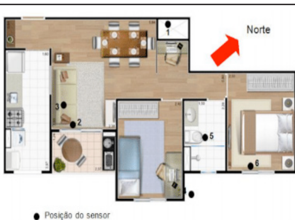
Figura 3 – Instalação dos sensores no apartamento do estudo de caso 1.
