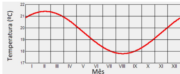
Figura 10 - Curva da temperatura do solo ao longo do ano.
