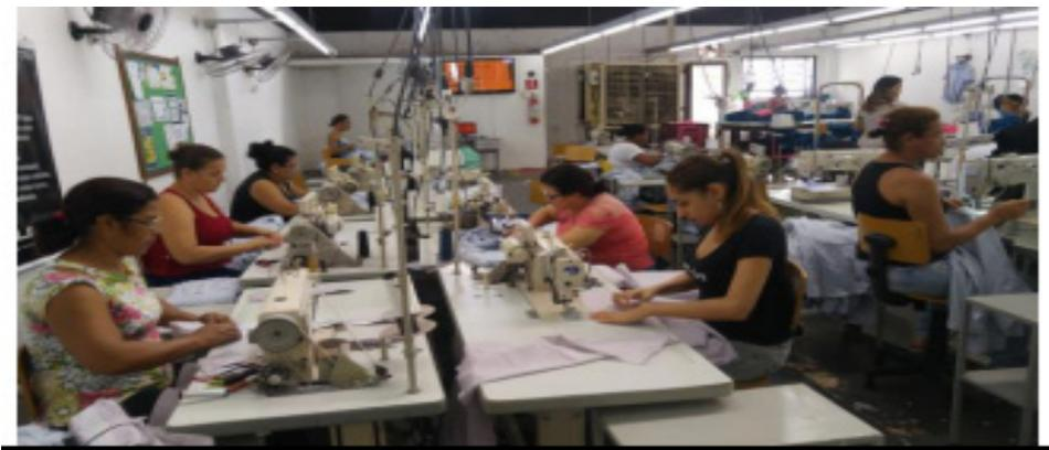
Figura 8: Célula da camisaria antes da aplicação do fluxo contínuo.
