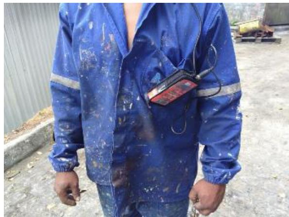
Figura 4 – Posicionamento do dosímetro
