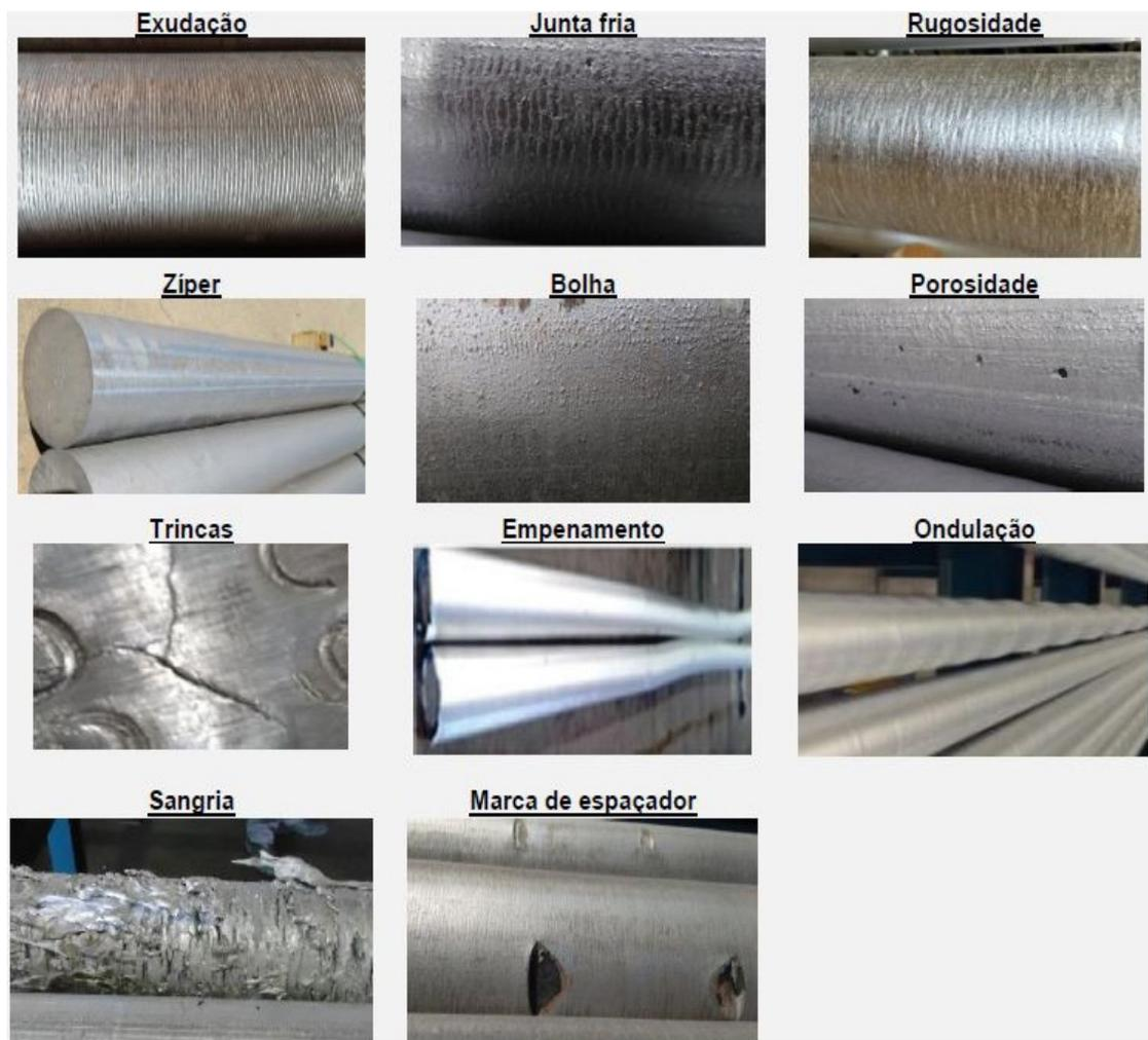
Figura 2 – Não conformidades na superfície de tarugos
