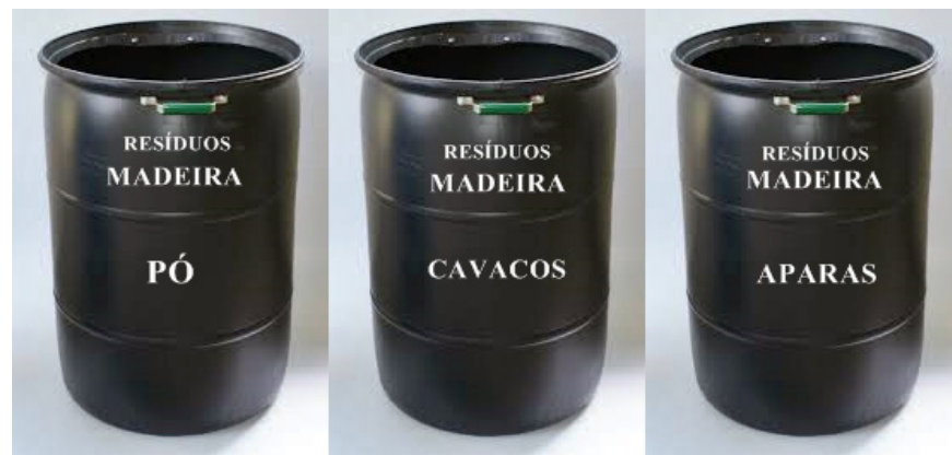
Figura 12: Tambores para acondicionamento dos resíduos (pó de serragem, cavacos e aparas).
