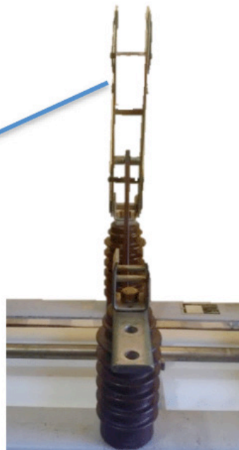
Figura 2 – Peça para reflexão do sinal de ultrassom
