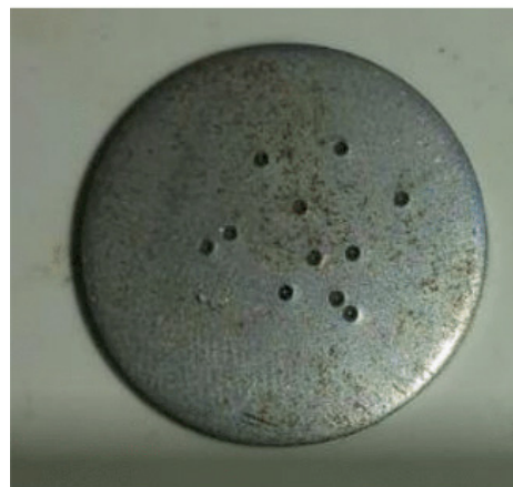
Figura 3 – Corpo de prova após o teste de dureza
