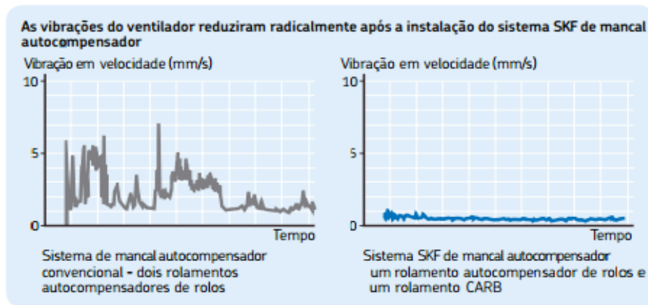
Figura 7: Gráfico comparativo da vibração antes e depois
