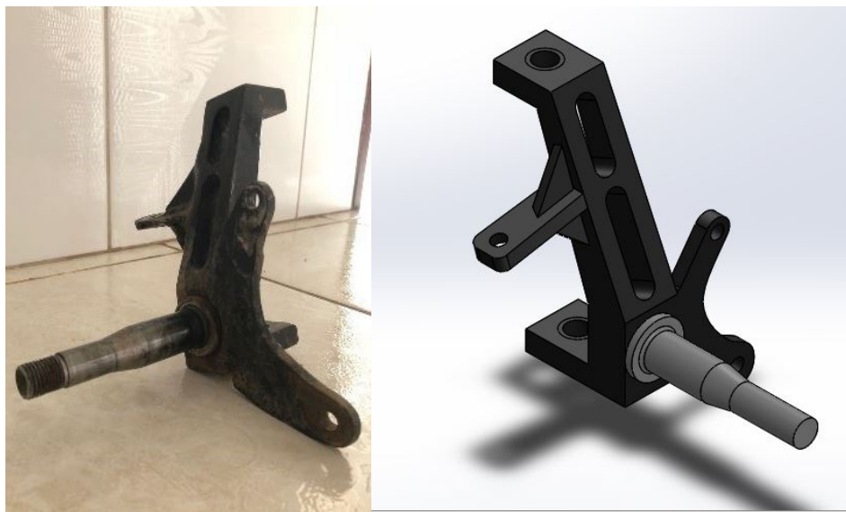
Figura 16 – Eixo do montante em CAD e fabricado
