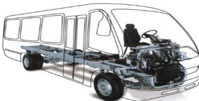
Figura 1. Carroceria sobre o chassi
