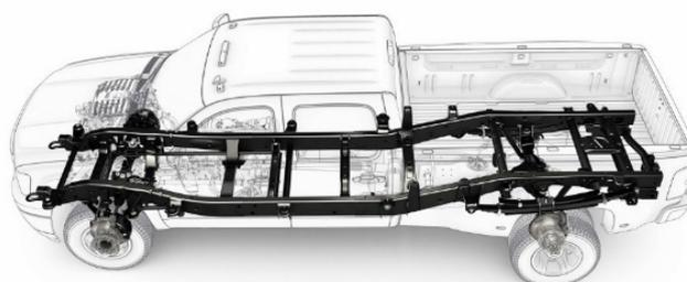
Figura 2. Carroceria sobre o chassi
