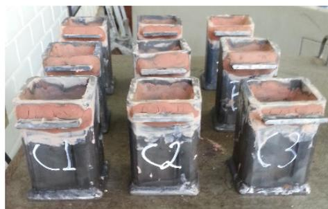
Figura 2. Caixas para a cementação
