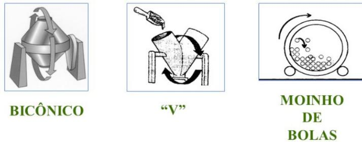
Figura 2. Misturador bicônico, em V e cilíndrico.
