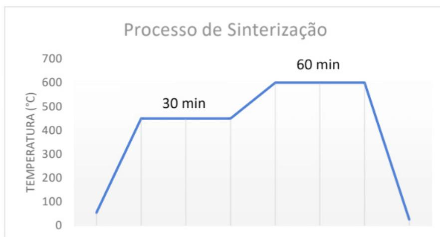
Figura 8. Gráfico esquemático do processo de sinterização.
