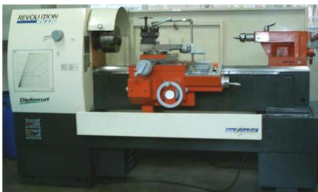
Figura 4. Torno mecânico universal Diplomat<sup>®</sup> modelo Revolution RV-220 utilizado nos ensaios de temperatura de usinagem
