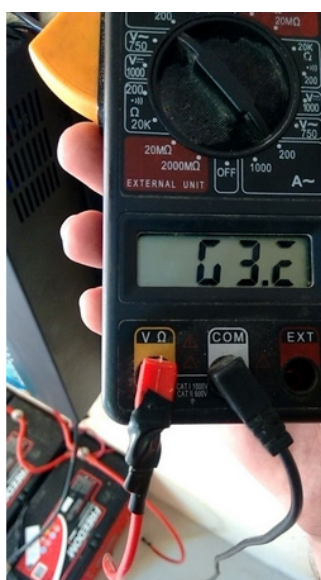
Figura 06 - Medição da corrente da saída CA do sistema
