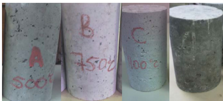
Figura 3 - Classificação dos corpos de prova em função da temperatura de exposição.
