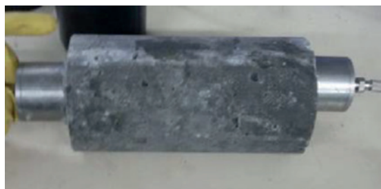
Figura 4 – Utilização dos transdutores no ensaio de ultrassom.
