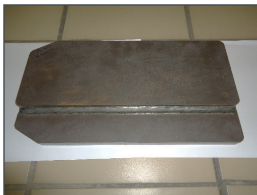
Figura: Corpo de prova para medição Medição da peça apenas ponteadada
