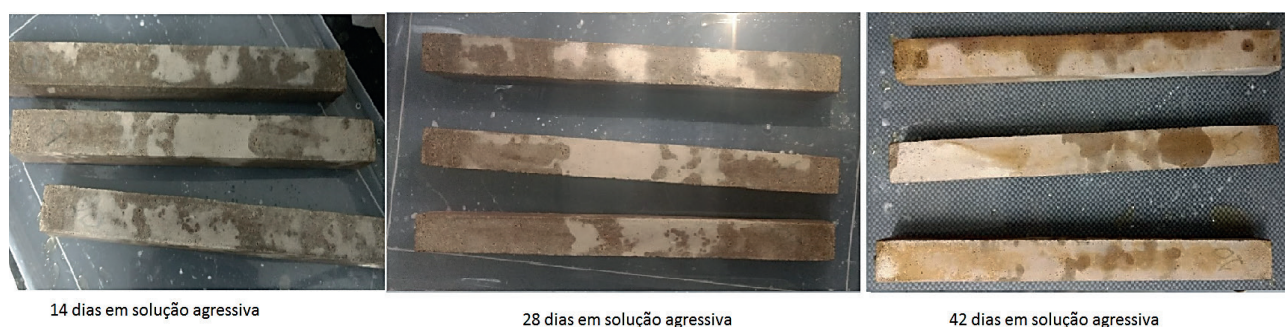
Figura 5 – Degradação por sulfato de magnésio
