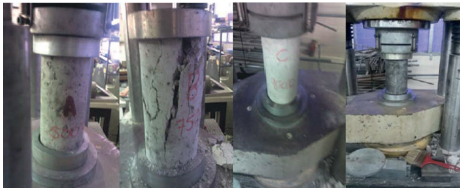
Figura 5 – Ensaio de compressão de corpos de prova.
