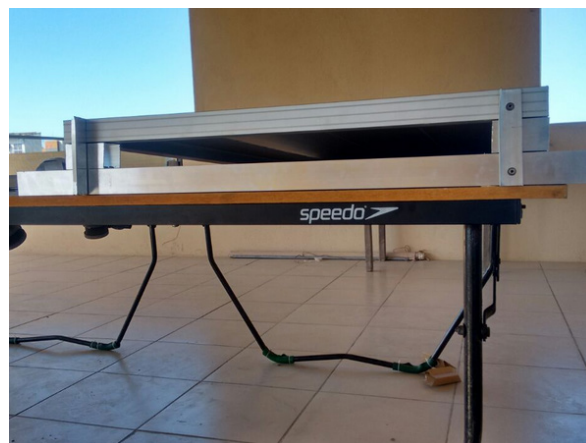
Figura 04 - Adaptação da altura do suporte do painel para fixação no telhado
