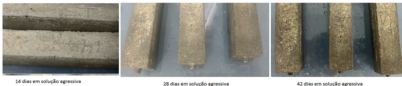
Figura 4– Degradação por sulfato de sódio
