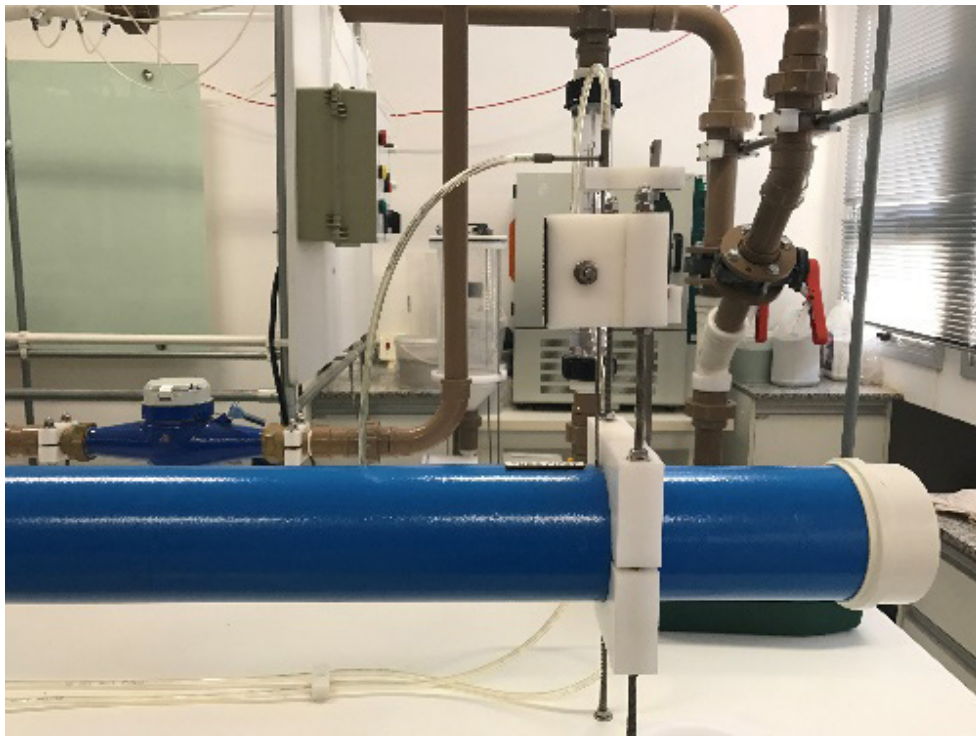
Figura 1 – Tubo de Pitot instalado
