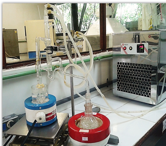
Figura 2 – Sistema utilizado durante o procedimento de Destilação-Extração-Simultânea.
