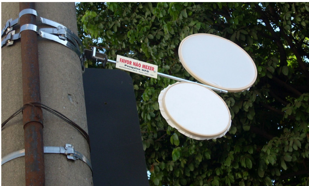
Figura. 1. Sistema de monitoramento passivo montado com barra de alumínio de \frac{1}{4} " e dois bastidores para bordado em madeira, onde foram fixados os elementos adsorventes, montado em poste de energia elétrica.
