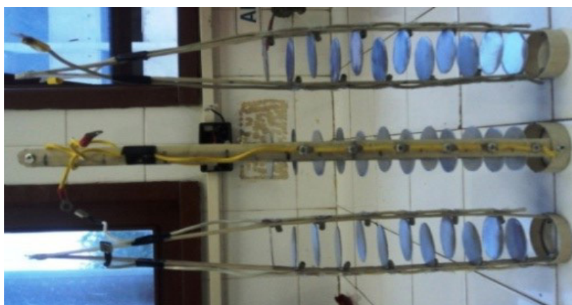
Figura 4. Eletrodos de alumínio distribuídos alternadamente em forma de chicanas.
