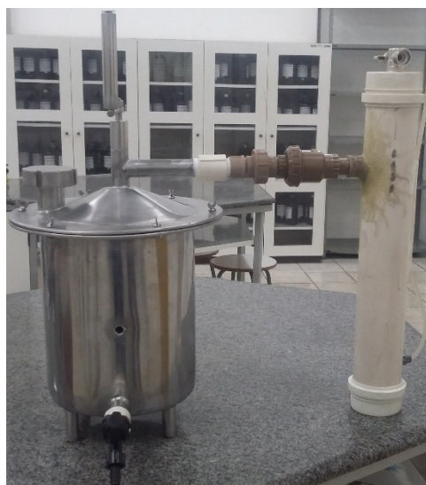
Figura 2 – Sistema de biodigestão anaeróbia
