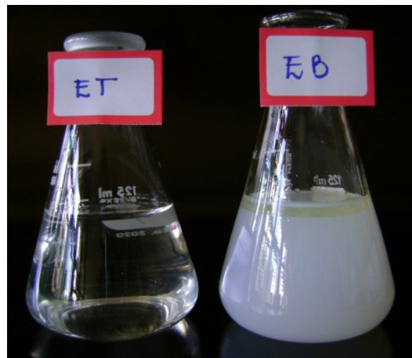
Figura 6. Diferença de clarificação entre o efluente tratado (ET) e bruto (EB).
