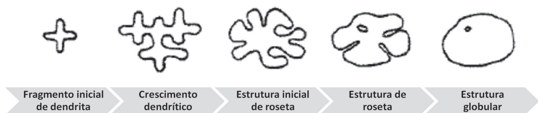
Figura 3 - Evolução da estrutura durante a solidificação sob vigorosa agitação (FLEMINGS, 1991).
