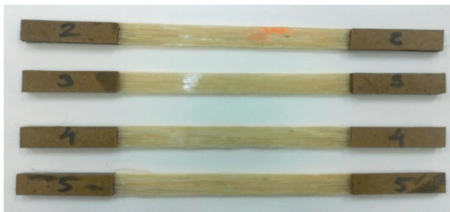
Figura 3. Corpos de prova prontos para o ensaio de tração.
