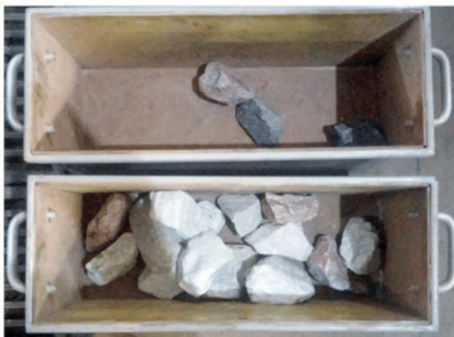
Figura 5: amostras retiradas do sorter após processo de triagem através sensor ótico (câmera CCD). Nota-se a presença de unicamente rejeito na bandeja superior e unicamente produto na bandeja inferior.
