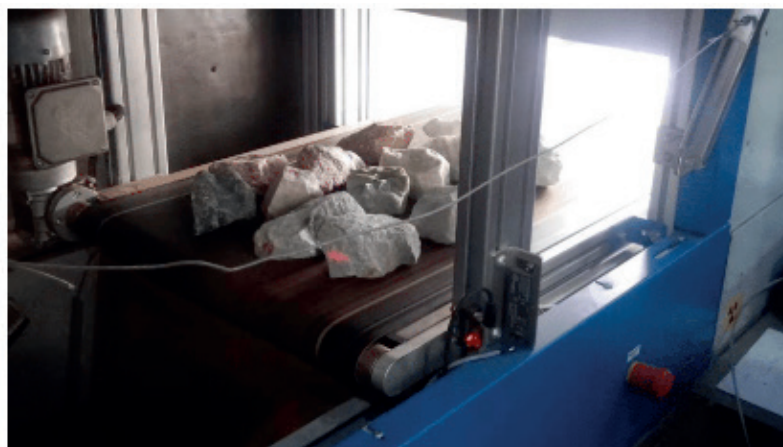
Figura 3: amostras posicionadas no interior do sorter , na zona de detecção, durante calibração.
