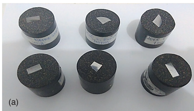
Figura 3: Algumas amostras metalográficas lixadas e polidas prontas para o ataque químico.
