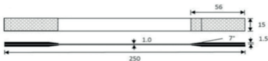
Figura 2. Dimensões do corpo de prova segundo a norma ASTM D3039M.
