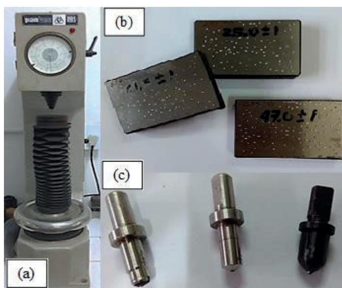
Figura 4. Equipamento do ensaio de dureza. (a) Durômetro PANTEC, modelo RBS-M; (b) corpos de prova padronizados para aferição da máquina; (c) endentadores
