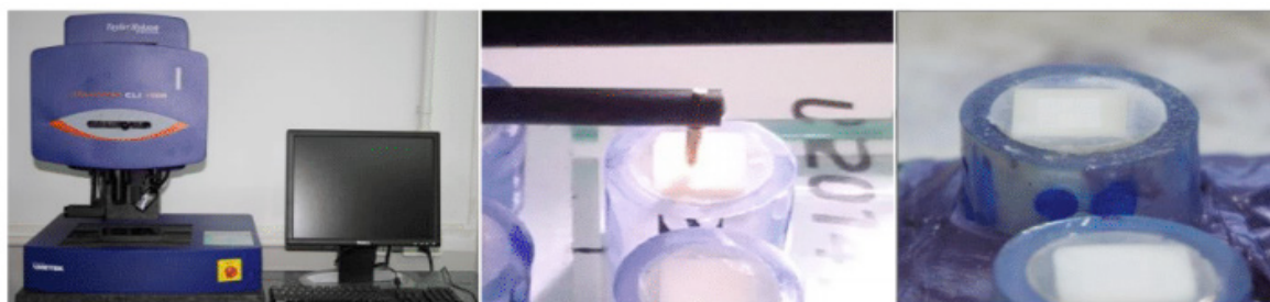
Figura 7. Perfilômetro digital acoplado a um computador com um software específico
