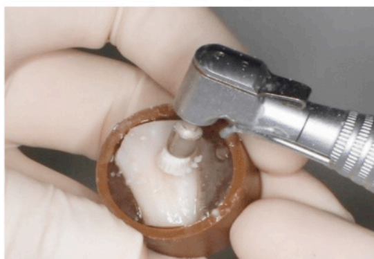
Figura 1: Profiliação do corpo de prova com pedrapomes e água.
