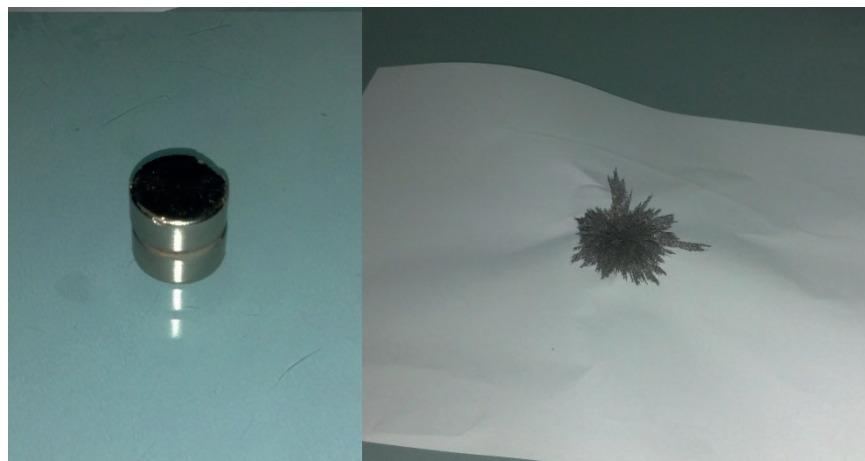
Figura 6: ímã de neodímio e o campo formado com limalha
