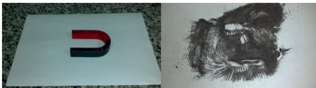
Figura 7: ímã tipo ferradura e as linhas de campo correspondentes
