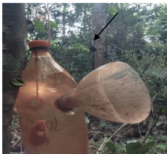
Figura 2: Armadilha do tipo passiva feita com garrafa PET, com o chumaço de algodão pendurado no seu interior. A seta indica uma abelha Euglossini atraída pela essência aromática.
