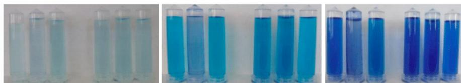
**Figura 5.** Fotos das soluções referentes aos espectros apresentados. Em cada foto, os tubos Eppendorfs da esquerda contém 0; 1,5 e 16 mM de SDS e os da direita contém 0; 0,75 e 8 mM de CTAB. Nas fotos da esquerda, centro e direita, as concentrações de azul de metileno são respectivamente, 5, 50 e 150 µM. Observar as diferenças de tonalidade de azul. A tonalidade *royal* indica predominância de dímeros do corante e a tonalidade *cyan* indica predominância de monômero do corante.
