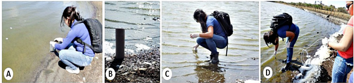
Figura 2: Procedimentos metodológicos: A. Coleta do sedimento para verificação de matéria orgânica; B. Corer inserido no sedimento; C. Coleta da água; D. Verificação da temperatura, salinidade e oxigênio dissolvido na água.
