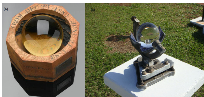
Figura 1: (A) Um Heliógrafo do Tipo Campbell, (B) Um Heliógrafo do Tipo Campbell/Stokes.
