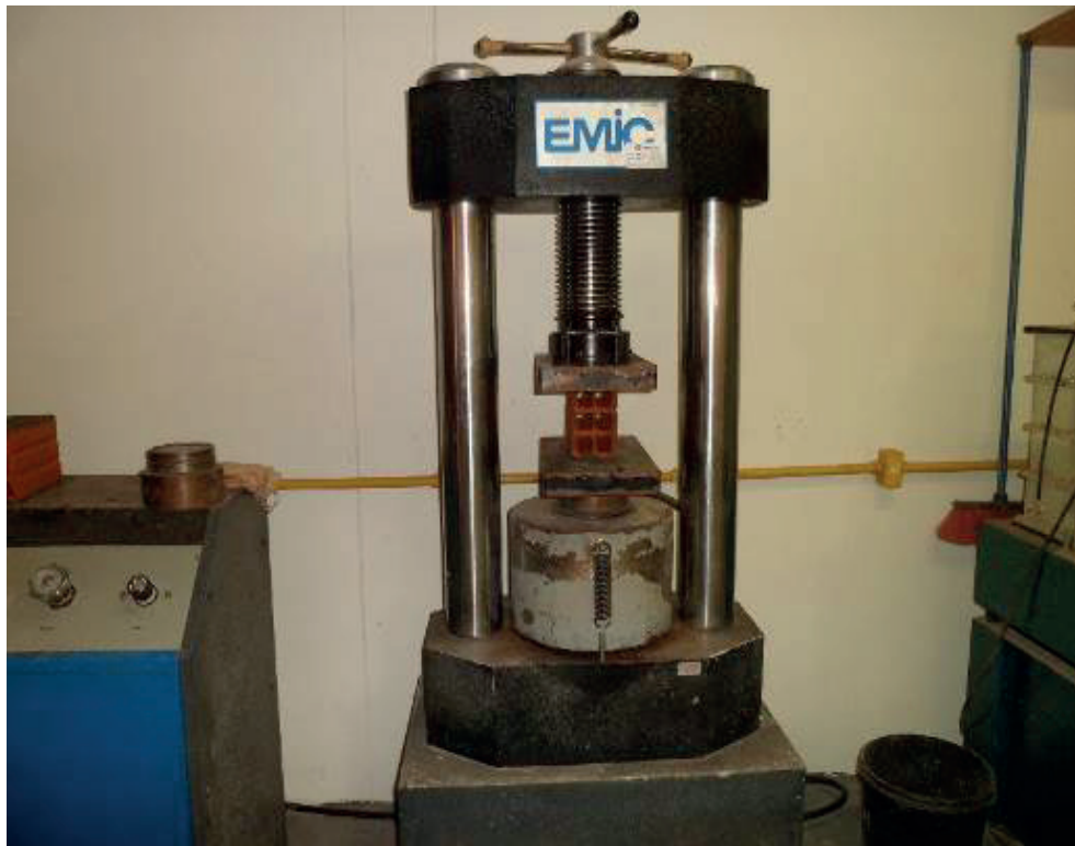
Figura 5: Ensaio de resistência mecânica à compressão. Fonte: Autor do Trabalho.
