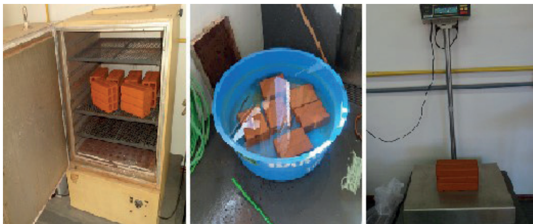
Figura 4: Realização do ensaio de absorção de água. Fonte: Autor do Trabalho.
