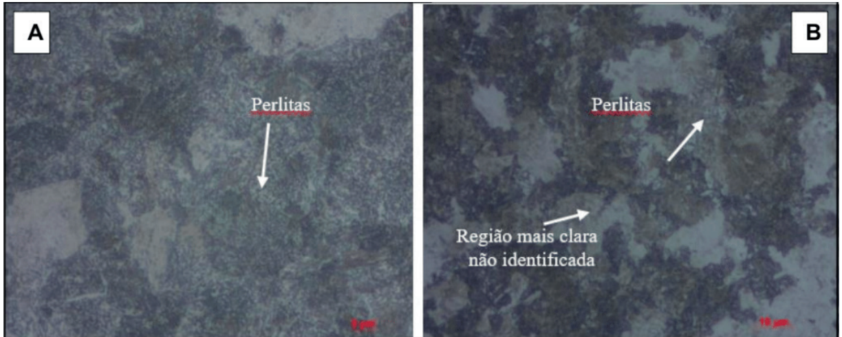
Figura 1 - Amostra em Condição Padrão, Ampliação de 1000x (A) e Amostra Normalizada, Ampliação de 1000x (B).
