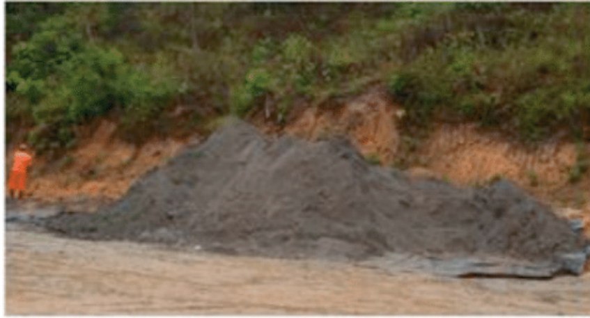
Figura 2. Cascalho de perfuração estocado após processo de perfuração do poço MG – 112, Campo de Miranga, Pojuca – BA (PIRES, 2009).
