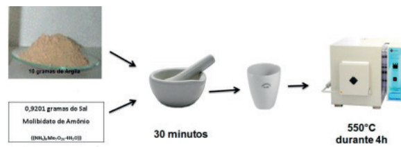
Figura 4: Esquema de impregnação da bentonita com MoO 3 .
