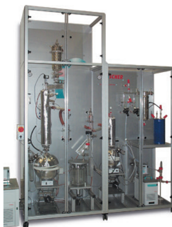
Figura 2. Equipamento para destilação de ponto de ebulição verdadeiro (PEV) i-Fischer® DIST D-2892/5236 MC / FISCHER® AUTODEST® 800/860 MC. Fonte: https://www.htds.fr/en/labo-research/analytical-instruments/physico-chemical-analysis/petrochemical-analyser/laboratory-distillations/distillation-combined-semi-automatic-astm-d2892-d5236/ .
