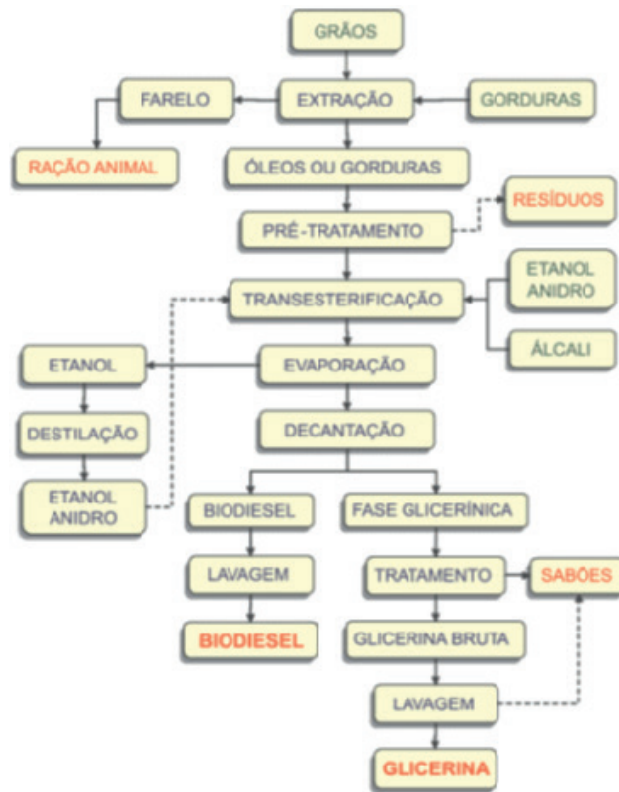
Figura 2. Fluxograma simplificado de produção de ésteres etílicos a partir de óleos vegetais e gordura animal.
