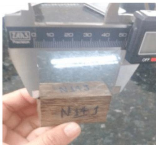
**Figura 3** – Paquímetro digital, medindo o corpo de prova.
