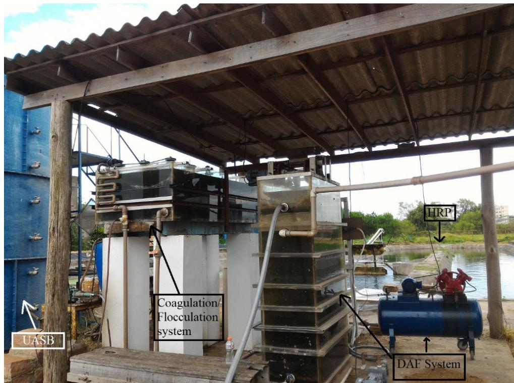
Fig. 1 – Sistema piloto de tratamento de efluentes.
