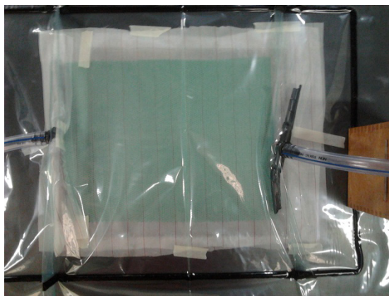
Figura 7. Processo de VRTM realizado na fabricação dos corpos de prova.
