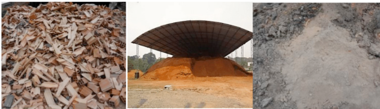
Figura 5 – a) Resíduos sólidos oriundos da quebra dos produtos cerâmicos após as etapas de queima e, inspeção e classificação; b) O pó de serra utilizado como combustível dos fornos é armazenado em galpão coberto em contato direto com o solo; c) Cinzas oriundas da combustão incompleta do pó de serra utilizado como combustível dos fornos durante a etapa de queima.
