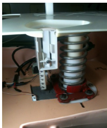
Figura 2 - mostra esta peça localizada no interior do tórax do manequim Ressuci Anne®, com o potenciômetro acoplado na UICV, podendo-se observar a marcação dos centímetros na peça.
