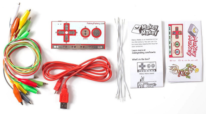
Figura 2: Kit Makey Makey e os cabos com clips tipo "jacaré" e o cabo USB para conexão
