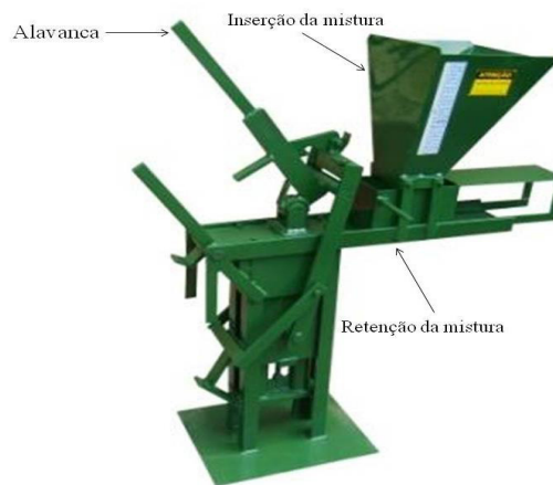
Figura 2. Prensa manual para a produção de tijolos
