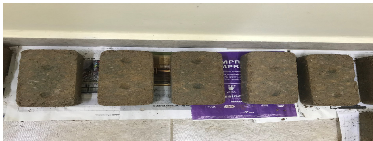
Figura 12. Tijolos com surgimento de fungos após 7 dias
