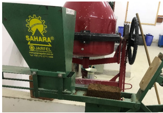
Figura 3. Tijolo solo-cimento após sua prensagem
