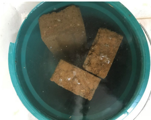
Figura 8. Tijolos submersos em água
