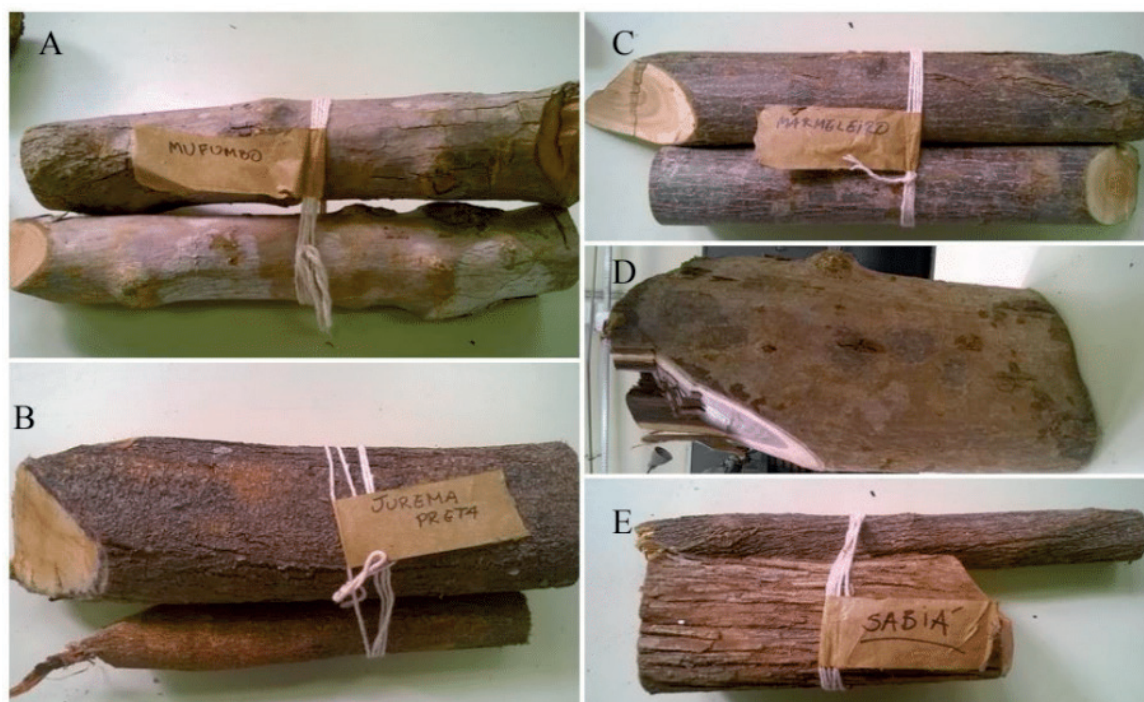
Figura 1. Madeiras utilizadas para o ensaio. Mufumbo- Campomanesia lineatifolia (A), Jurema Preta- Mimosa tenuiflora (B), Marmeleiro- Croton sonderianus (C), Pau preto- Dalbergia melanoxylon (D) e Sabiá- Mimosa caesalpiniaefolia (E)
