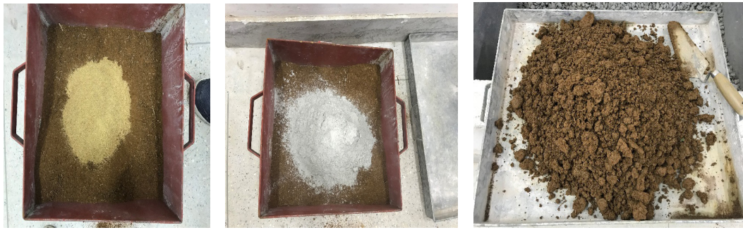
Figura 1. Sequência da mistura dos componentes do tijolo solo-cimento (A) Solo argiloso + Resíduo do caroço de azeitona (B) Solo argiloso + Resíduo do caroço de azeitona+ Cimento (C) Solo argiloso + Resíduo do caroço de azeitona+ Cimento+ Água
