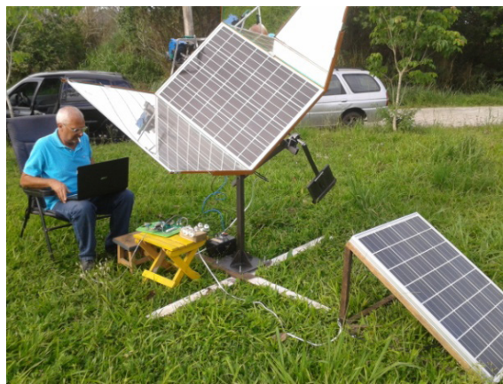
Figura 5 - Montagem da placa com espelhos.
