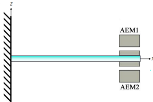
Figura 4. Posicionamento dos atuadores eletromagnéticos na viga de material compósito em engaste-livre.
