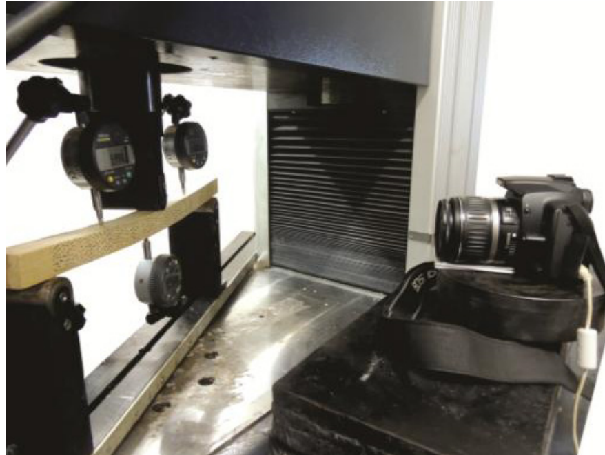
Figura 1. Vista geral da Máquina Universal de Ensaio, a instrumentação do ensaio de flexão estática para a aplicação da técnica PIV e os materiais ensaiados.
