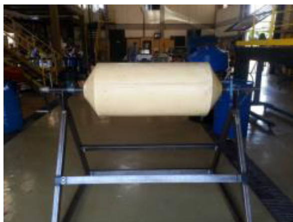
Figura 6. Defesa sem revestimento.
