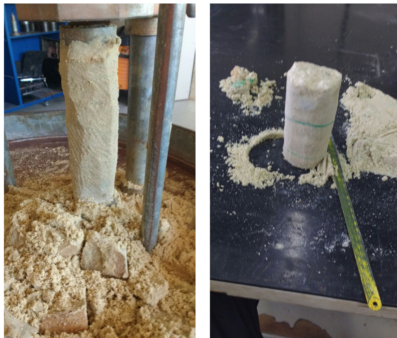
Figura 3. Moldagem dos corpos de prova para o ensaio de ultrassom e posterior compressão simples
