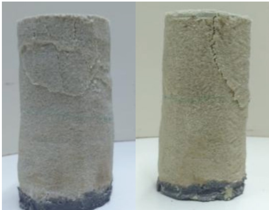
Figura 12. Ruptura dos corpos de prova CP_9 e CP11 respectivamente
