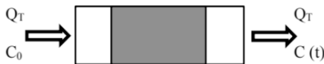
Figura 2 – Esquema de um leito fixo de carvão para adsorção.
