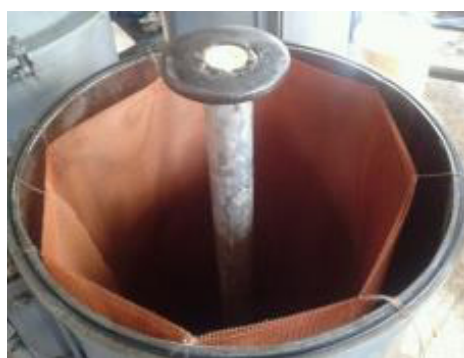
Figura 5. Molde com a malha de revestimentos em poliamida pronto para a injeção do PU.
