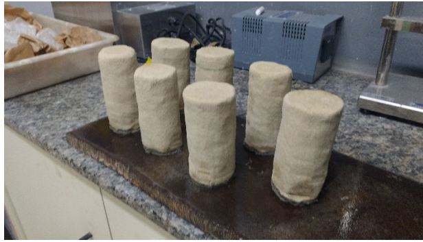
Figura 4. Processo de capeamento dos corpos de prova
