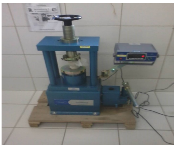
Figura 2: Equipamento utilizado no ensaio de resistência à compressão.
