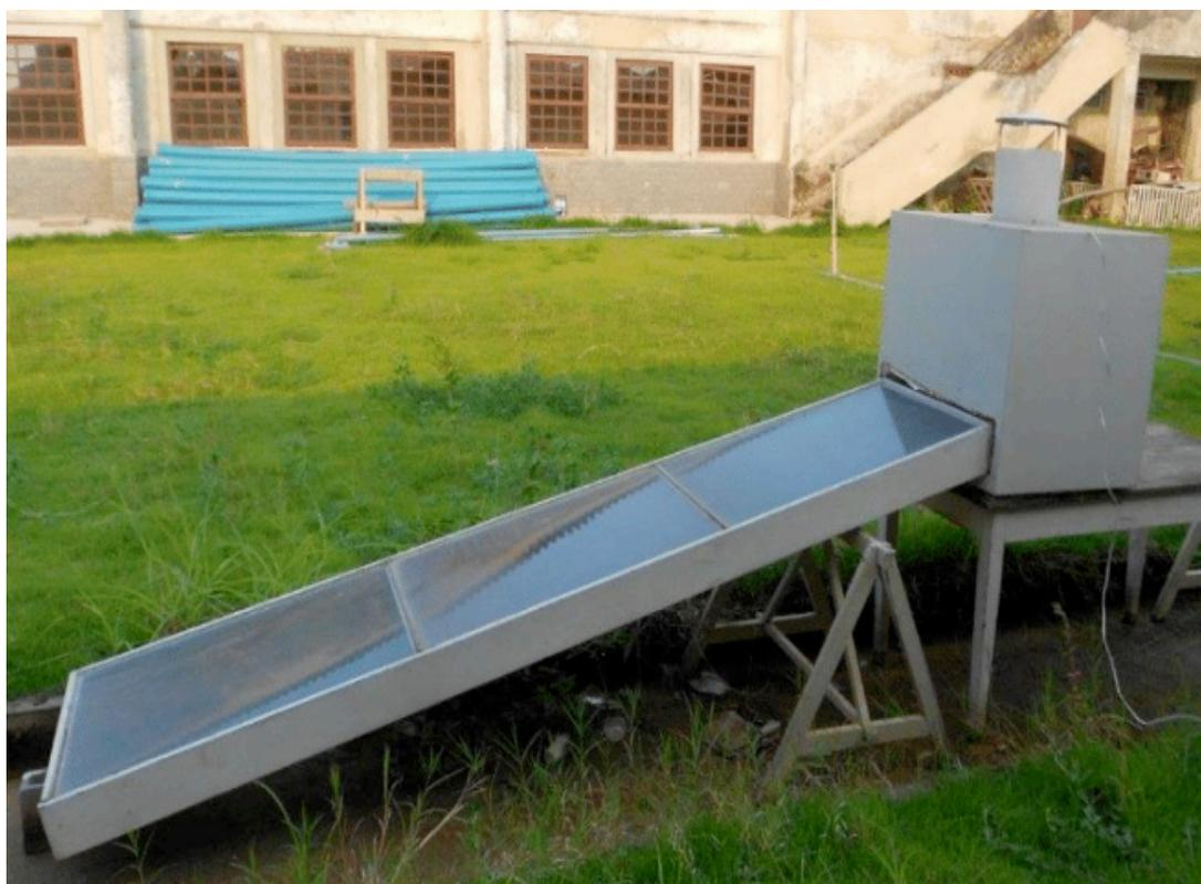
**Figura 1.** Secador híbrido solar-elétrico
