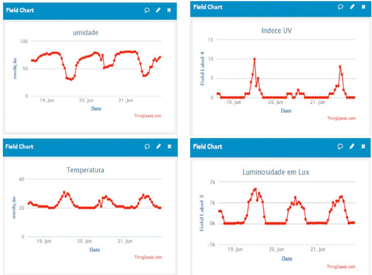
Figura 4 - Resultados da estação meteorológica na nuvem do ThingSpeak
