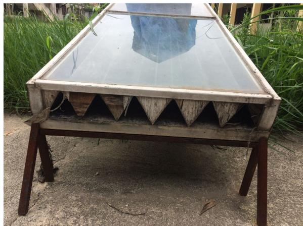
**Figura 3.** Cantoneiras sanfonadas em triângulo do coletor solar.
