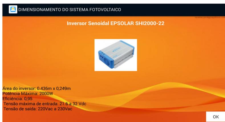
Figura 4 – Especificação do inversor
