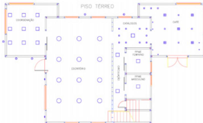
**Figura 8:** Planta esquemática dos equipamentos de iluminação artificial do EV pavimento térreo
