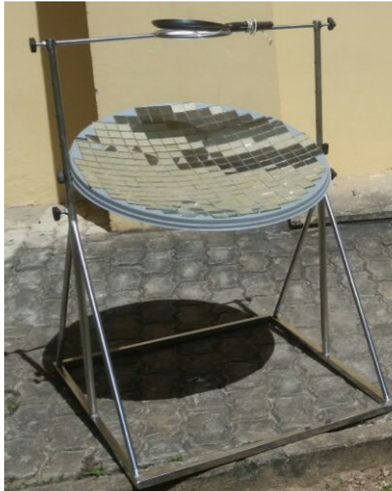
Figura 2: Detalhe do fogão solar com concentrador parabólico
