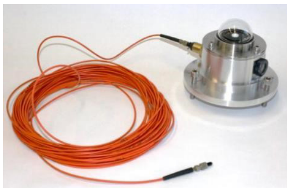
Figura 2 – Interface Óptica desenvolvida em laboratório para a coleta dos dados espectrais.
