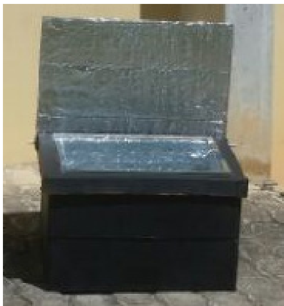
Figura 1: Detalhe do fogão solar tipo caixa
