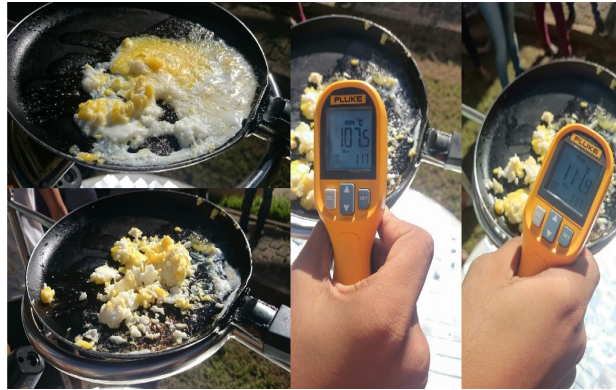
Figura 4. Frigideira, com ovo, colocada no foco do concentrador solar e o multímetro fazendo a leitura da temperatura na panela.
