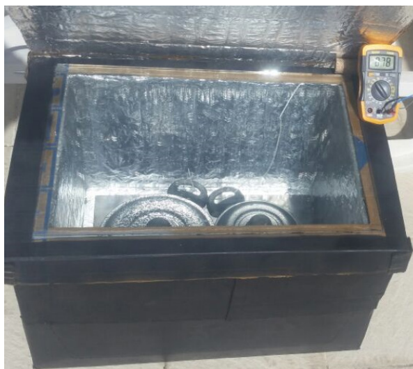
Figura 8: Fogão solar para cozimento de alimentos.
