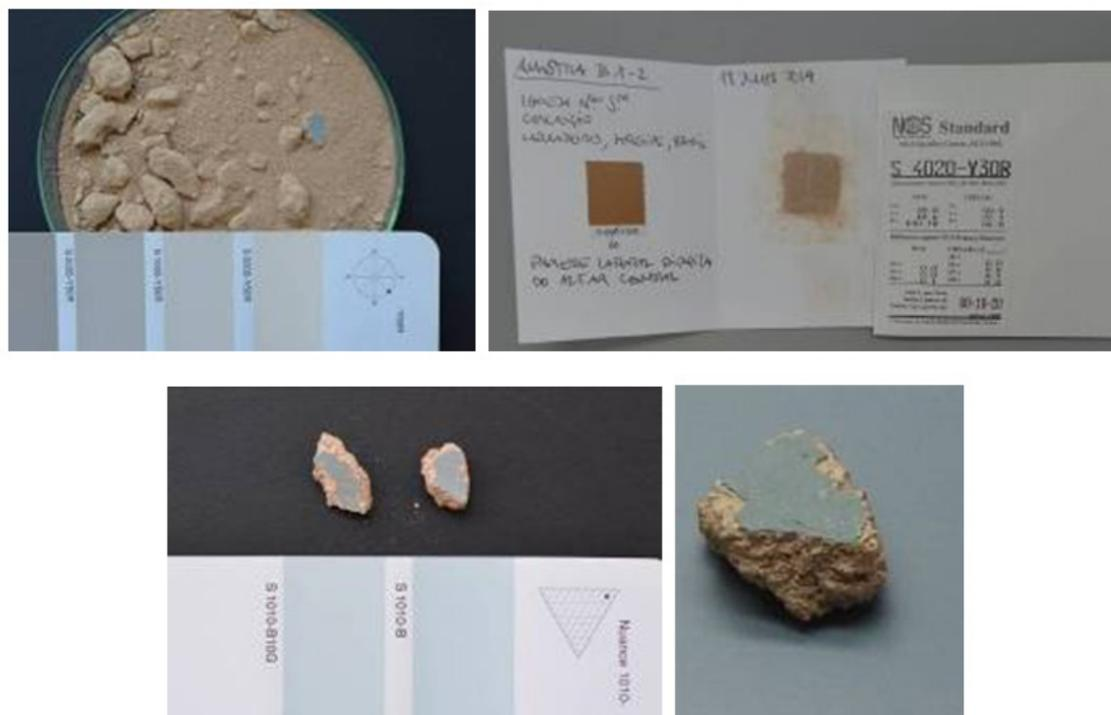
**Figura 8** – (acima esquerda): Observação da cor da argamassa no LNEC. (direita acima): Observação da cor da argamassa no MEDCROMA. (abaixo esquerda): Análise dos fragmentos 3 e 4 da amostra B<sub>1-2</sub> no LNEC. (direita abaixo): Detalhe do fragmento 4 analisado no LNEC e no MEDCROMA – pigmento azul. Fonte: Silva, jun. 2014.
