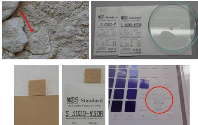
**Figura 10** – (acima esquerda): Detalhe do pigmento a base de cal analisado no LNEC. (acima direita): O pigmento apresentou duas cores no MEDCROMA. Fonte: Silva, jun. 2014. (esquerda e centro abaixo): Cor da argamassa da amostra  $C_{3-1}$  analisada no MEDCROMA. Fonte: Silva, jun. 2014. (direita abaixo): Cartela Munsell – cor **10PB 9/2**. Fonte: Silva, out. 2015.
