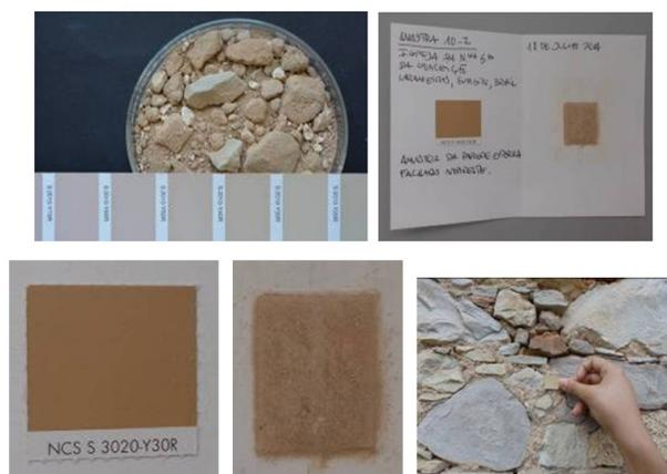
**Figura 5** – (acima esquerda): Análise do pó cerâmico 10<sub>1</sub> no LNEC. (direita acima): Análise do pó cerâmico no MEDCROMA. (esquerda e centro abaixo): pó cerâmico cor NCS **S 3020-Y30**.
