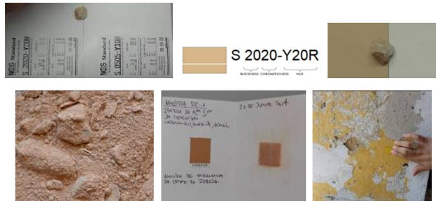
**Figura 11** – (esquerda acima): Fragmento  $D_{1-2}$  análise da cor no LNEC. (centro e direita acima): Análise da cor no MEDCROMA. (esquerda abaixo): Análises da amostra  $D_{2-1}$  feitas no LNEC. (abaixo centro): Análises da amostra  $D_{2-1}$  feitas no MEDCROMA. Fonte: Silva, jun. 2014. (direita abaixo): Comparativo visual superfície com cartela Munsell, pigmento do revestimento da torre **2.5Y 7/10**. Fonte: Silva, out. 2015.
