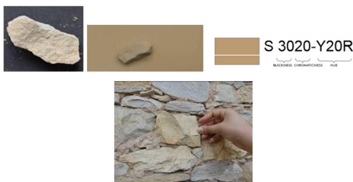
**Figura 6** – (acima esquerda): Pedra calcária analisada no LNEC. (centro acima) – Análise desta mesma pedra calcária no MEDCROMA. (direita acima): Cor da pedra calcária NCS **S 3020-Y20R**. Fonte: Silva, jun. 2014. (abaixo): Comparativo visual superfície com cartela Munsell – pedra calcária – cor **2.5Y 8/4**. Fonte: Silva, out. 2015.
