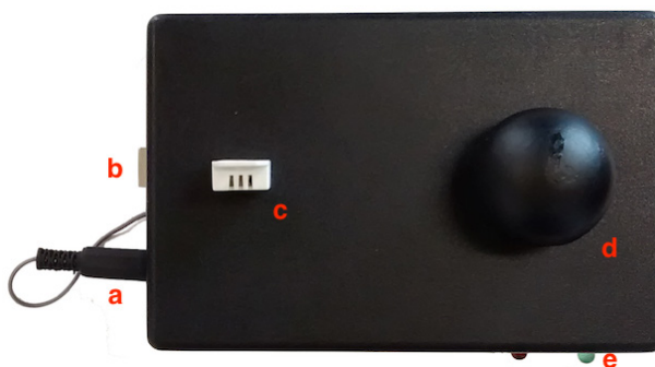
Figura 5. Vista superior de dispositivo portátil – Fonte externa de alimentação (a); Entrada USB tipo B (b); Sensor de temperatura e umidade relativa AM2302 (c); Termômetro de globo negro (d); LEDs (e)
