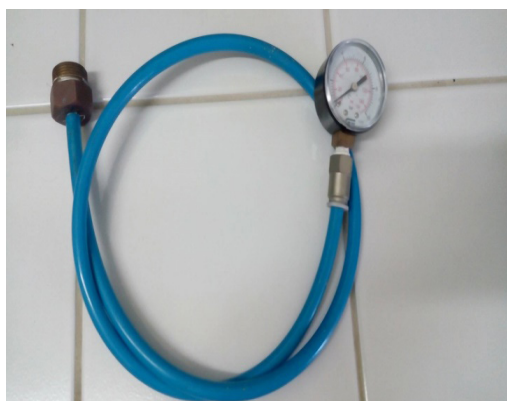
Figura 2 - Manômetro GE em escala psi, acoplado a mangueira de pressão e adaptador de rosca 3/4" e 1/2"
