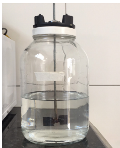
Figura 3 – Reservatório reacional com sistema de agitação inserido.
