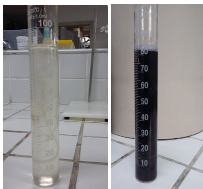
Figura 8 – Solução de amido/iodeto: a) Solução não oxidada; b) Solução oxidada.
