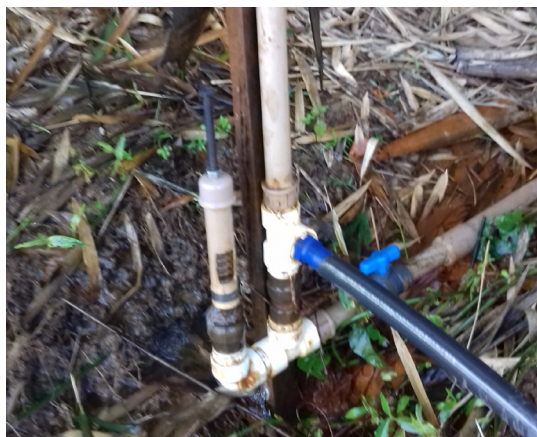
Figura 1. Carneiro hidráulico artesanal utilizado.
