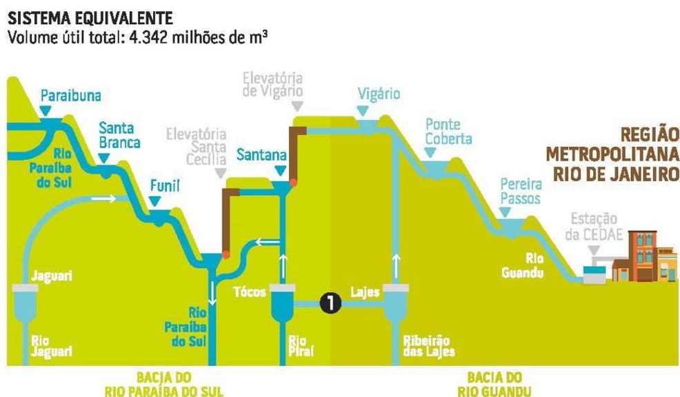
FIGURA 6 – Esquema do Sistema Equivalente do Complexo Hidráulico Paraíba do Sul
