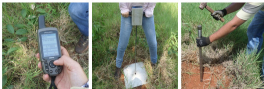
Figura 2. Georreferenciamento dos pontos amostrais (a); mensuração da resistência do solo à penetração (b) e coleta de solo em duplicata (c).
