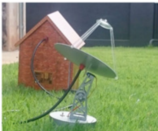
Figura 6 – Teste do protótipo funcional do coletor solar
