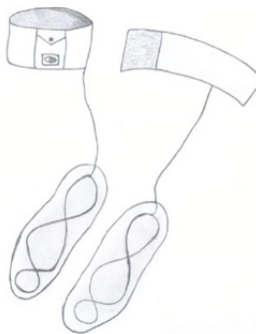
Figura 2 - Ilustração da palmilha com sistema de aquecimento
