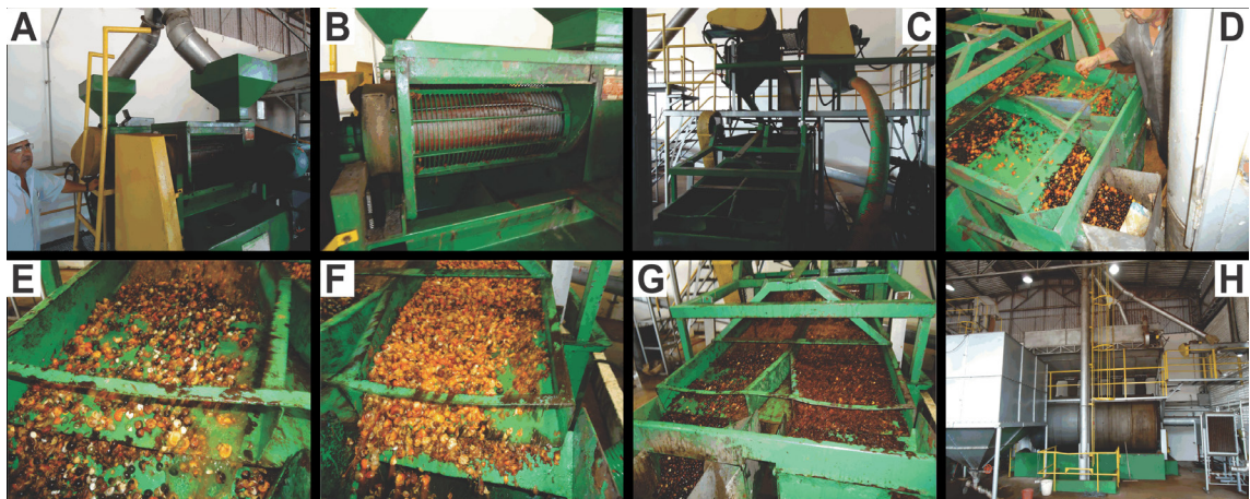
Figura 1 – Vista do maquinário antigo da Jayoro, constituído de despoldador (a, b), lavador/separador (c, d, e, f, g) e secador rotativo (h).
