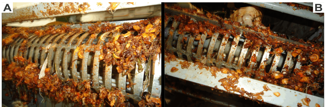
Figura 3 – Detalhes do despolpamento do guaraná durante os testes realizados, destacando a peneira original da Econoflex (a, b).
