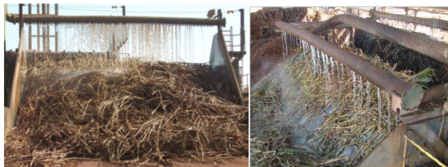
Figura 1: Ilustração da limpeza da cana-de-açúcar com água na recepção (Fonte: Embrapa, 2014; SBA; STAB; CTC; 2012).
