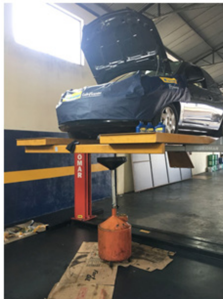
Figura 4 - Utilização do papelão como forro de piso
